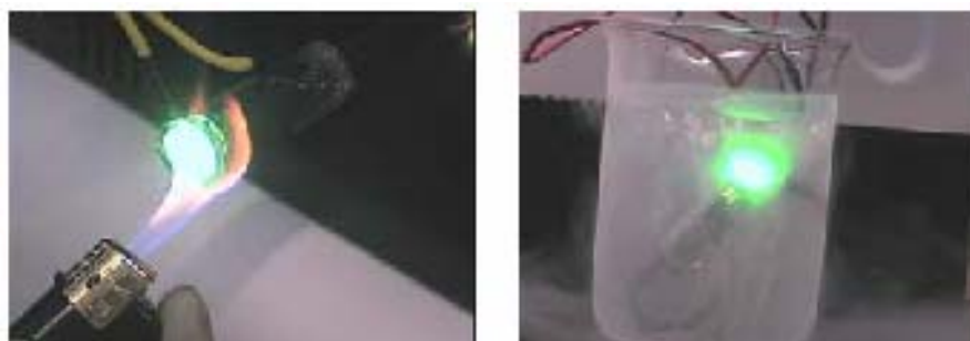
Рис.4. Фотографии испытаний: катодолуминесцентная пальчиковая лампа подвергается нагреву открытым огнем (слева) и глубокому охлаждению в жидком азоте (справа).
